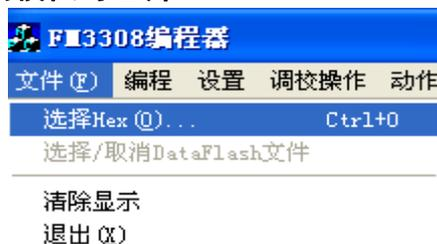
在选取如上图的操作后，选择一个适合的 Hex 程序文件，然后在显示框中会显示已选中的文件路径，如下图：
