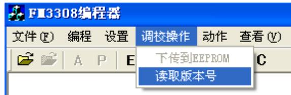
在选取如上图的操作后，会在工具栏下方的显示框中显示调校仪的相应版本号，以此识别相应调校仪的版本和性能。
